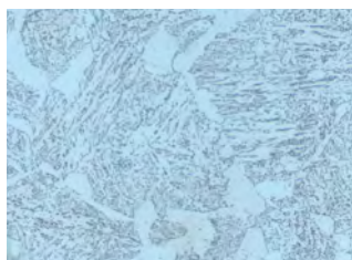
Kern in GKZ-geglüht (Vergrößerung 500:1)
