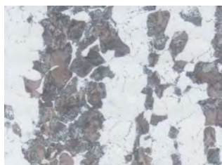
Kern in FP-geglüht (Vergrößerung 500:1)
