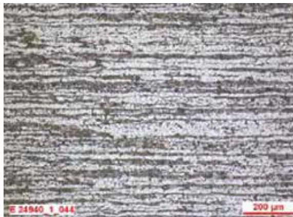
Längsschliff, gezogen 19.0 mm, Probenlage 1/2 Radius, Ätzung HNO 3 -2 %-ig
