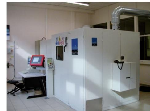
Industrielle Kaltstauchmaschine mit instrumenteller Ausrüstung zur Beurteilung der Leistungsfähigkeit unserer Produkte
