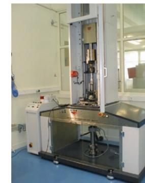
Fallgewichtsgerät zur Bestimmung des Verhaltens von nichtrostendem Stahl in Abhängigkeit von der Verformungsgeschwindigkeit und Temperatur (20 bis 300 °C)
