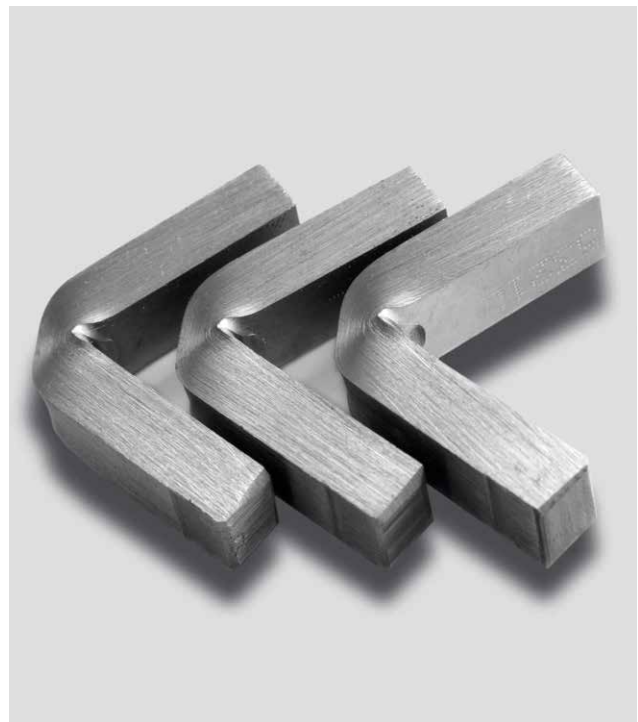
Schlagbiegeproben (gehärtet und angelassen auf 44-46 HRc) nach Prüfung im 450J Pendelschlagwerk
