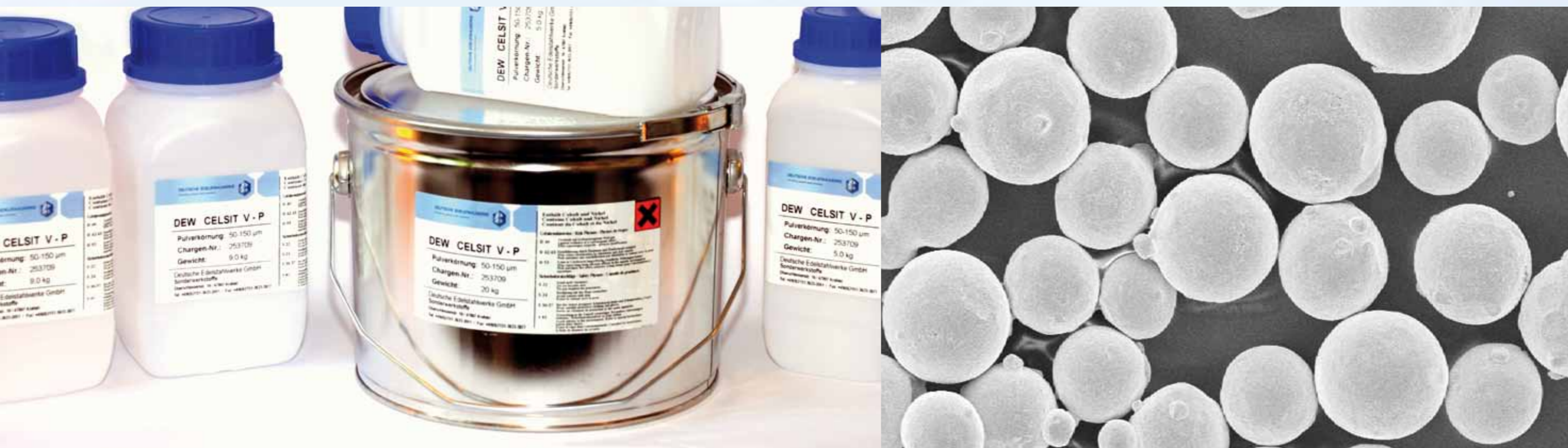
Raster-Elektronen-Mikroskopische Aufnahme (REM) von gasverdünsten kugeligen Metallpulverkörnern
