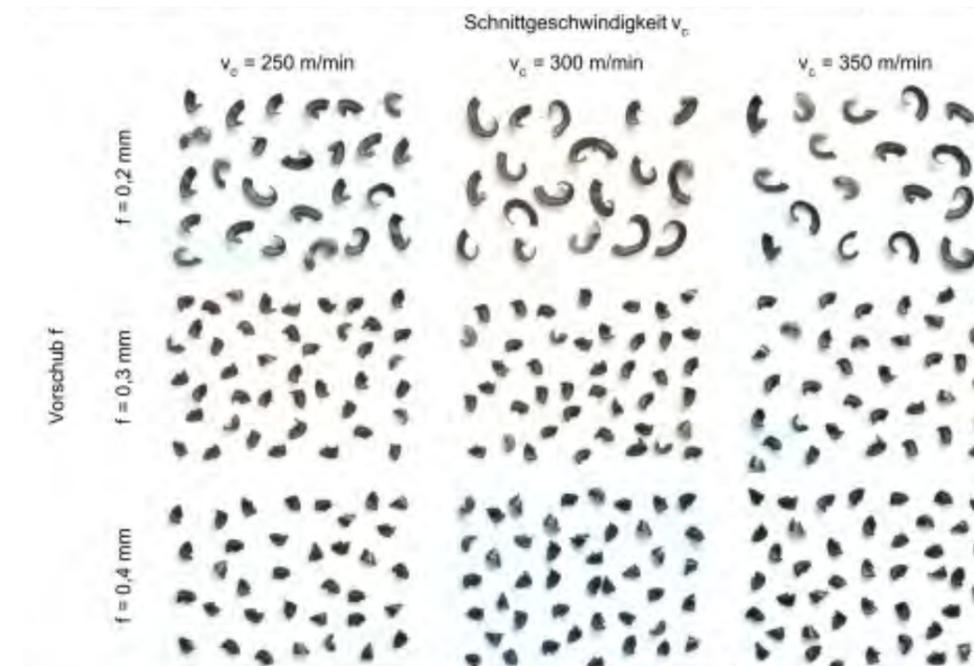
Einfluss der Schnittwerte auf die Spanform/ 18CrNiMo7-6, S = 0,0200 %
