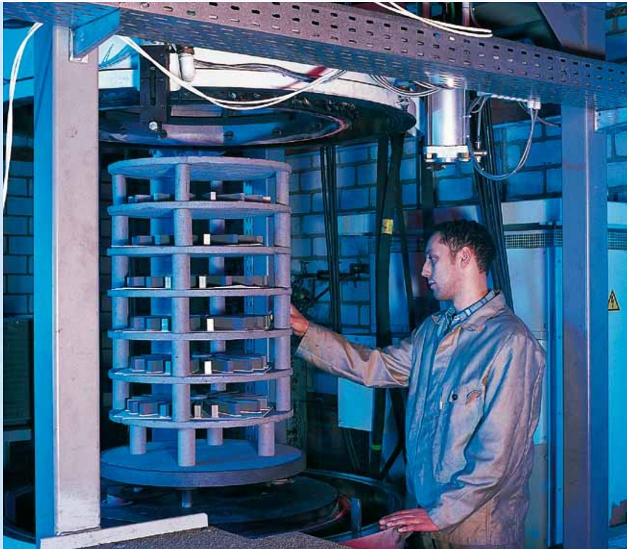
Chargierung von Messerleisten
